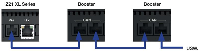
Der **Z21 XL BOOSTER** wird vorzugsweise mit dem beiliegenden CAN-Bus-Kabel mit der **Z21 XL Series** Zentrale über die CAN-Buchse verbunden. Dabei ist es unerheblich, welche der beiden CAN-Buchsen
