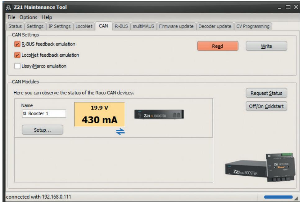
Un tableau de bord s'affiche pour chaque sortie de booster Z21 avec la tension actuelle et la consommation de courant de la sortie de voie correspondante. Cliquez sur le tableau de bord pour activer la sortie du booster correspondant à partir de votre PC ou la désactiver pour dépannage (gestion du booster).
