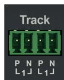
Der **Z21 XL BOOSTER** verfügt über zwei gleichwertige, intern verbundene Gleisanschlüsse, die insgesamt max. 6 A abgeben können.
