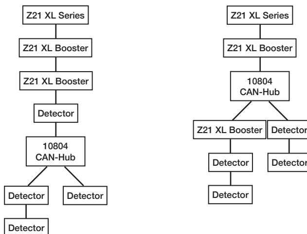
Falls an der Zentrale keine CAN-Buchse vorhanden ist, dann kann der **Z21 XL BOOSTER** alternativ auch mit einem vierpoligen B-Bus-Kabel (10757) mit der Z21 Series Zentrale über die „**B-Bus**“-Buchse verbunden werden. Bei älteren Zentralen kann der Anschluss auch als „Booster out“ bezeichnet sein. Dabei ist es unerheblich, welche der beiden Buchsen am Booster verwendet wird.
