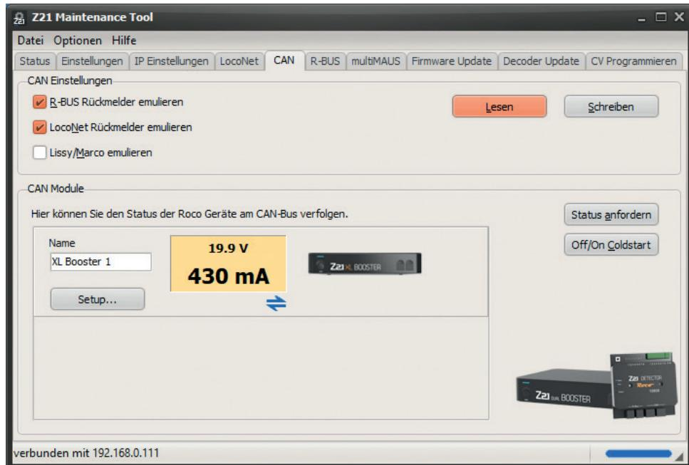
Es erscheint pro Z21-Booster-Ausgang ein Panel mit der aktuellen Spannung und dem Stromverbrauch des jeweiligen Gleisausgangs. Durch einen Klick auf das Panel können Sie den entsprechenden Booster-Ausgang vom PC aus komfortabel aktivieren oder zwecks Fehlersuche deaktivieren (Booster Management).
