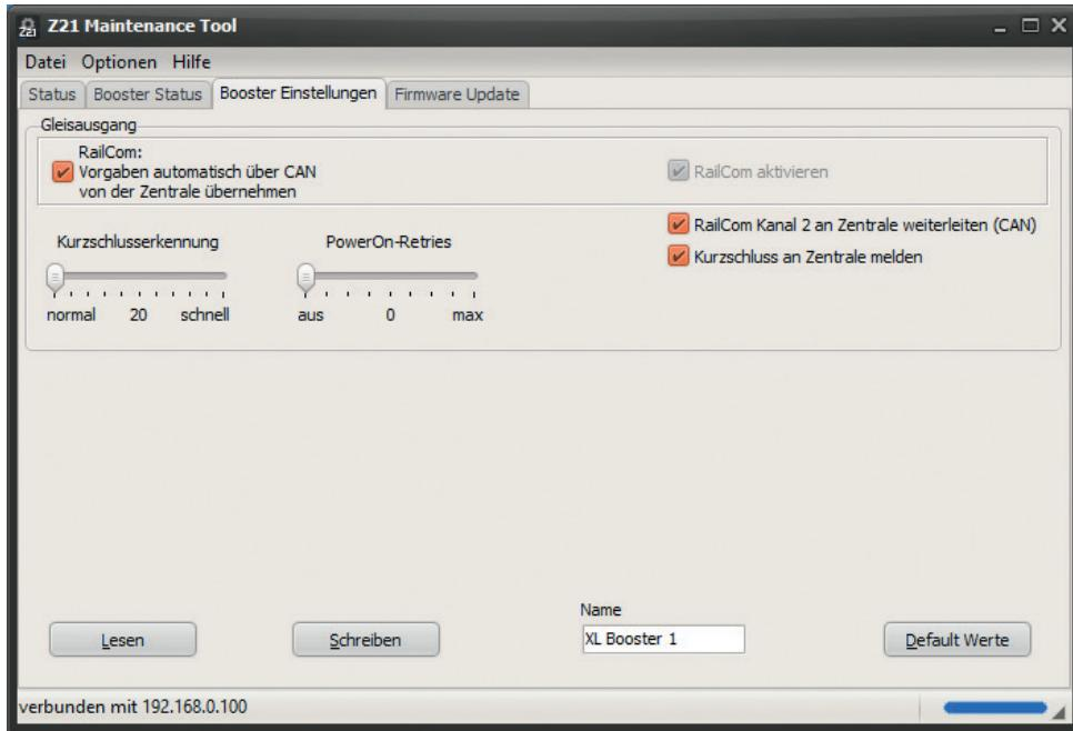
Der Konfigurations-Bildschirm ist dabei sehr ähnlich aufgebaut wie der Konfigurationsdialog über CAN. Beschreibung der einzelnen Einstellungen siehe oben Abschnitt „Konfiguration und Firmware Update über CAN und Z21-Maintenance-Tool“.
