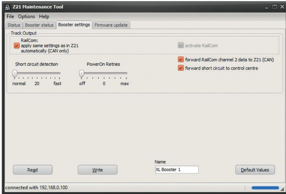
L'écran de configuration est conçu de façon similaire à la fenêtre de dialogue de configuration par CAN. Vous trouverez une description de toutes les paramètres dans le chapitre « Configuration et mise à jour du firmware par CAN avec l'outil de maintenance Z21 ».
