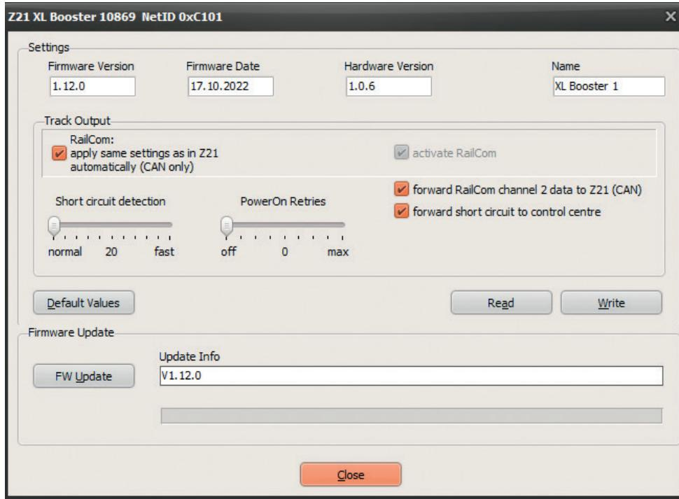
**RailCom :** Transfert automatique des paramètres de la centrale par CAN (« Auto-Settings » activé par défaut)
