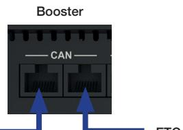
Le Z21 XL BOOSTER est de préférence connecté à la centrale série Z21 XL ar la prise CAN et le câble CAN-Bus fourni. Il n'est pas important de savoir laquelle des deux prises CAN est utilisée sur le booster.
