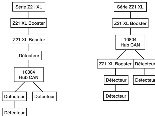
Si la centrale ne dispose pas d'une prise CAN, le **Z21 XL BOOSTER** peut aussi être connecté à la centrale série Z21 par la prise « **B-Bus** » avec un câble B-Bus à quatre broches (10757). Sur les centrales plus anciennes, la connexion peut être aussi appelée « **Booster out** ». Il n'est pas important de savoir laquelle des deux prises est utilisée sur le booster.
