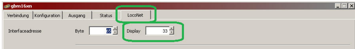
Abbildung 26 GBM16XN Konfigurationssoftware – LocoNet Display Adresse
