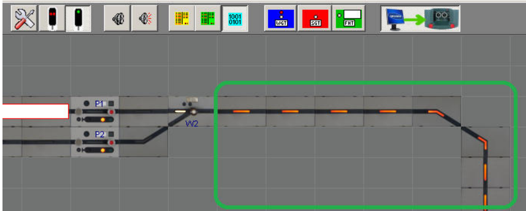
Abbildung 31 ModellStw - Darstellung des belegten Blocks
