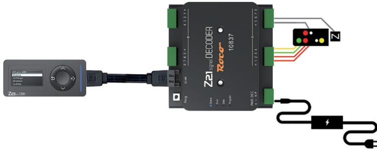
Il peut aussi l'être au travers de la prise USB. Dans ce cas, Le Z21 pro LINK peut alors alimenter l'appareil compatible zLink. Pour cela, utilisez le bloc d'alimentation et de commutation USB 5 W Réf. 10859.
