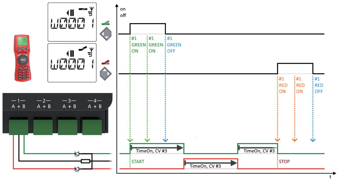
En option : Variation lente d'intensité (simulation de lampes à incandescence).
