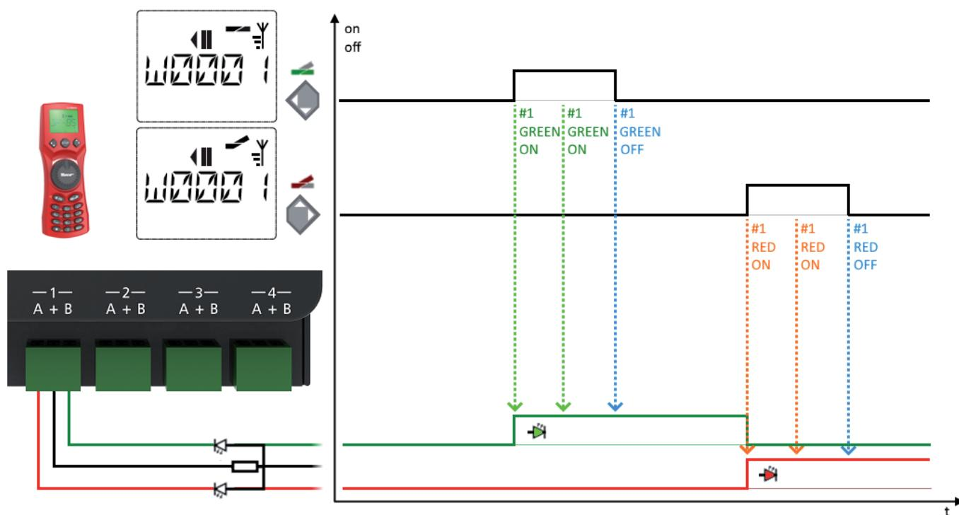
En option : Variation lente d'intensité (simulation de lampes à incandescence).
