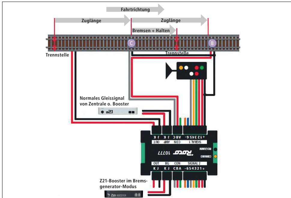
Die Länge des Halteabschnitts entspricht einer maximalen Zuglänge plus dem Bremsweg (ggf. in den Decoder-Einstellung anpassen).
