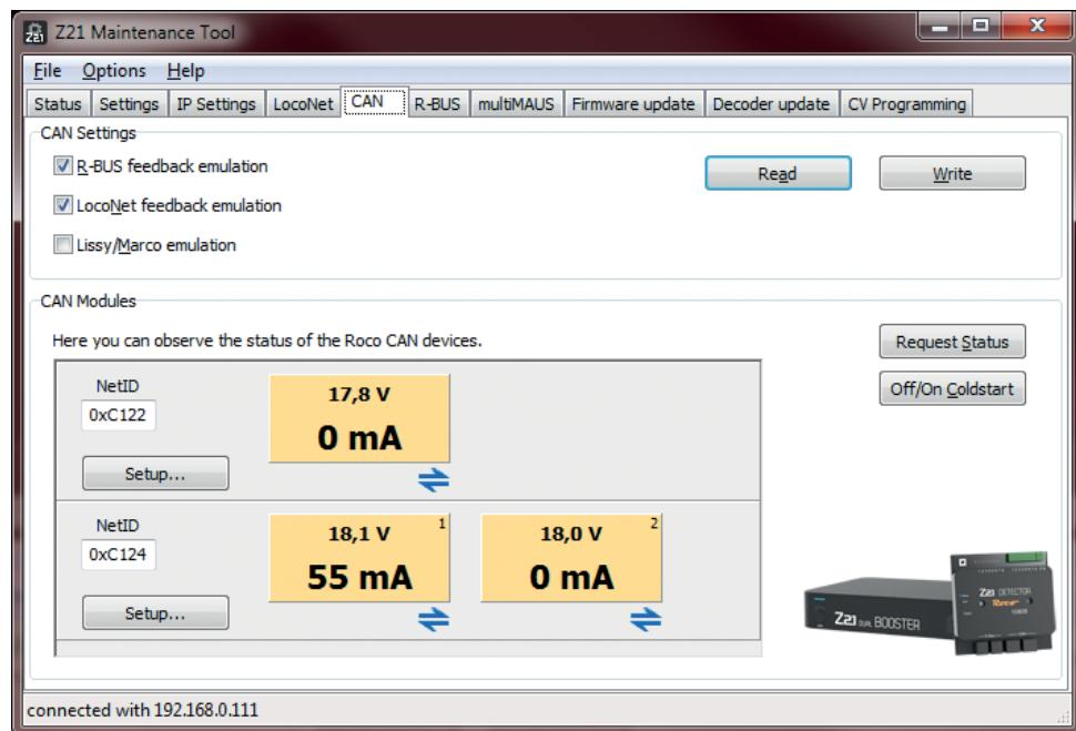
Selon le type du Booster, Single ou Dual, un ou deux panneaux apparaissent avec la tension actuelle et la consommation en électricité de la sortie de voie respective.
