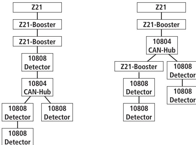
Le Z21-Booster peut également être raccordé au Z21 ou Z21start avec le câble B-Bus tétrapolaires (fourni) via le connecteur "B-Bus". Pour les centrales les plus anciennes, le raccord peut également être indiqué comme "Booster out". Les deux connecteurs au Booster peuvent être ici utilisés.
