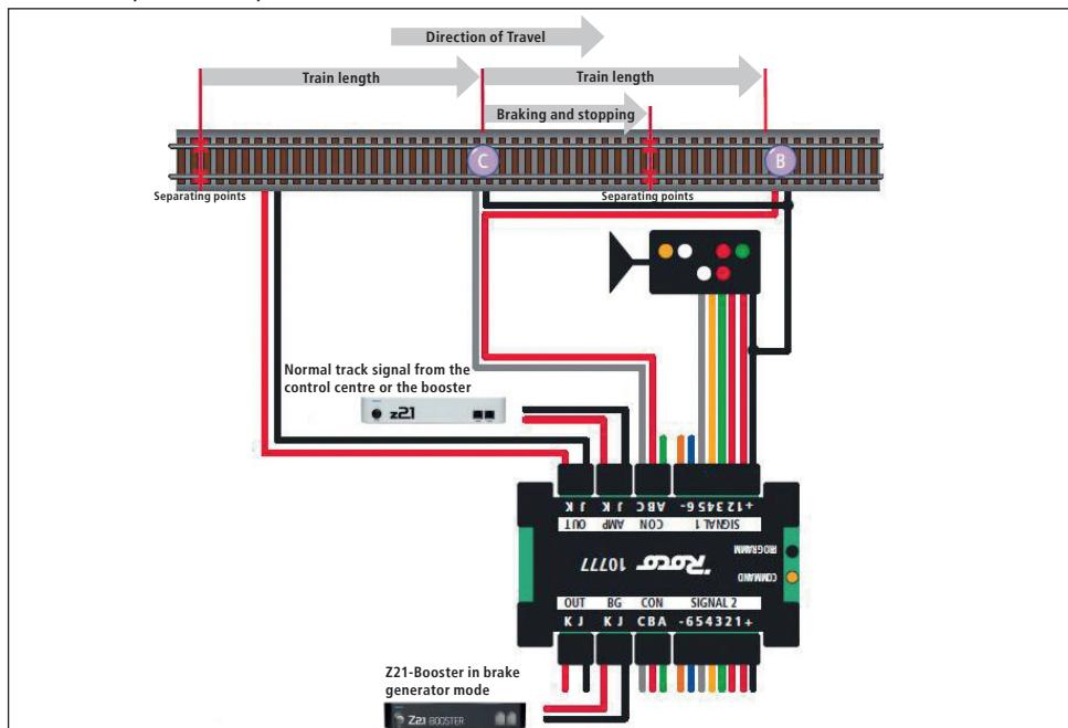
La longueur de la section d'arrêt correspond à la longueur maximale du train et à la distance de freinage (ajustez éventuellement le réglage du décodeur).
