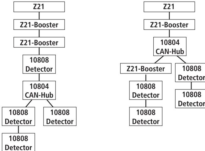
Der Z21-Booster kann auch mit dem beiliegenden vierpoligen B-Bus-Kabel mit der z21 oder z21start über die „B-Bus“-Buchse verbunden werden. Bei älteren Zentralen kann der Anschluss auch als „Booster out“ bezeichnet sein. Dabei ist es unerheblich, welche der beiden Buchsen am Booster verwendet wird.
