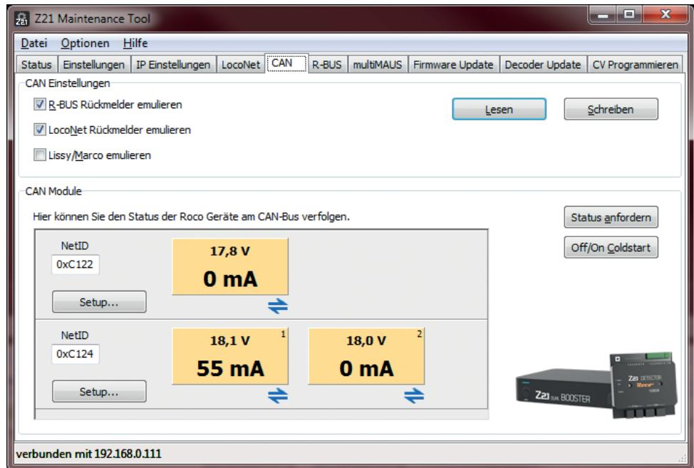
Je nach Typ, Single oder Dual Booster, erscheinen ein oder zwei Panels mit der aktuellen Spannung und dem Stromverbrauch des jeweiligen Gleisausgangs.
