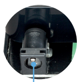
Schaltnetzteil: 12 -24 V DC Ausgangsstrom- mindestens: 3A
