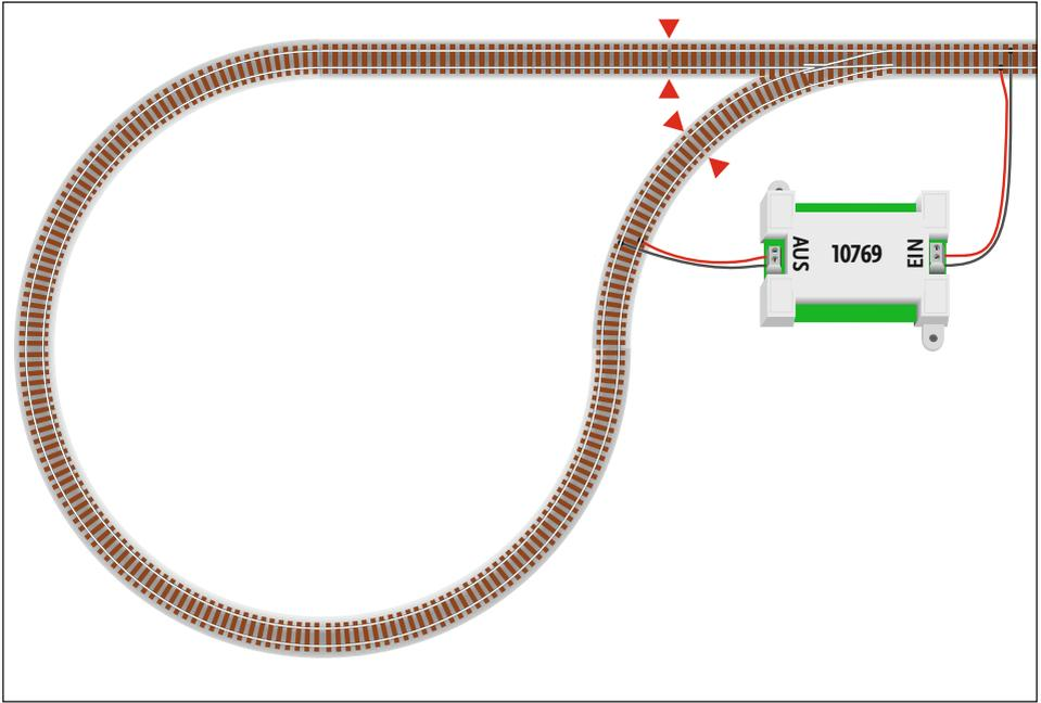
Eine digitale Kehrschleife mit dem Kehrschleifenmodul 10769.
