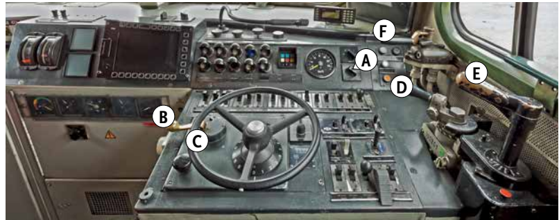
Die BR 218 hat ein Drehrad zum Beschleunigen und drei Bremsen (Wagenzugbremse, Hydraulische Bremse und Zusatzbremse).
